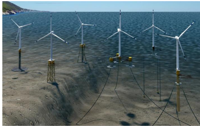
Illustrations des différentes techniques de fixation des éoliennes sur les fonds marins
